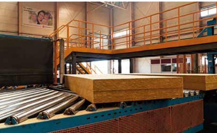
встроенную в непрерывный процесс производства утеплительных материалов. Упаковочная пленка направляется в качестве вторичного сырья в соседний цех по производству полимерных изделий.
