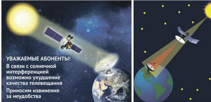
Солнечная интерференция происходит дважды в год – весной и осенью. Солнце, спутник связи и земная приемная станция «встают» в одну линию на несколько минут, затем спутник связи уходит из-под «солнечной засветки».
