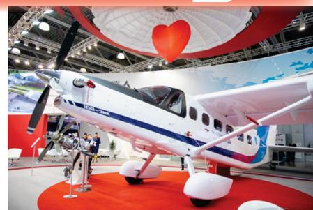
целевой самолет, предназначенный для использования на местных воздушных линиях и авиационных работ. Рассчитан на перевозку до 9 пассажиров или до 2 тонн груза на дальность 1,5 – 3 тыс. км. «Байкал» создается для широкой области применения: грузовые и пассажирские перевозки, лесопатрульные и прочие мониторинговые работы, санавиация, спасательные и сельскохозяйственные работы.
