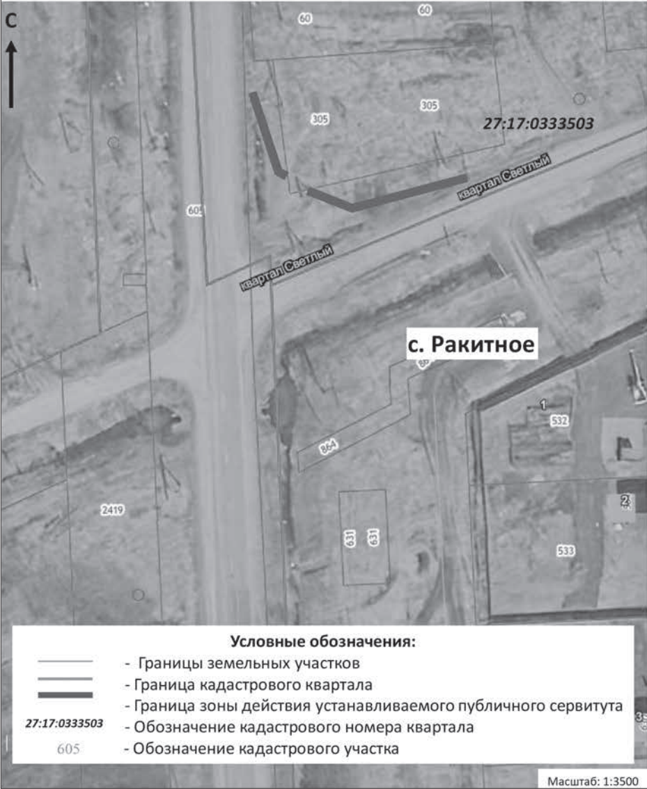
СХЕМА ГРАНИЦ ДЕЙСТВИЯ ПУБЛИЧНОГО СЕРВИТУТА, ДЛЯ РАЗМЕЩЕНИЯ ВЛ-10 кВ Ф-2 ПС «РАКИТНОЕ» Местоположение: Хабаровский край, Хабаровский район
