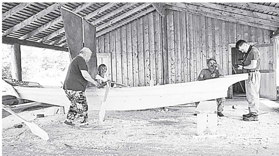
УГДА – СОСТАВНАЯ ДОЩАТАЯ ЛОДКА, КОТОРАЯ НА ПРОТЯЖЕНИИ ВЕКОВ БЫЛА ОСНОВНЫМ ВИДОМ ТРАНСПОРТА НА АМУРЕ.
